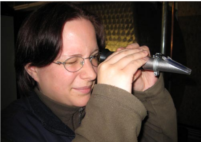
Bild 3 und 4: Ein Blick durch das Okular: Die Linie der farblich von einander getrennten Bereiche zeigt den Messwert an.
